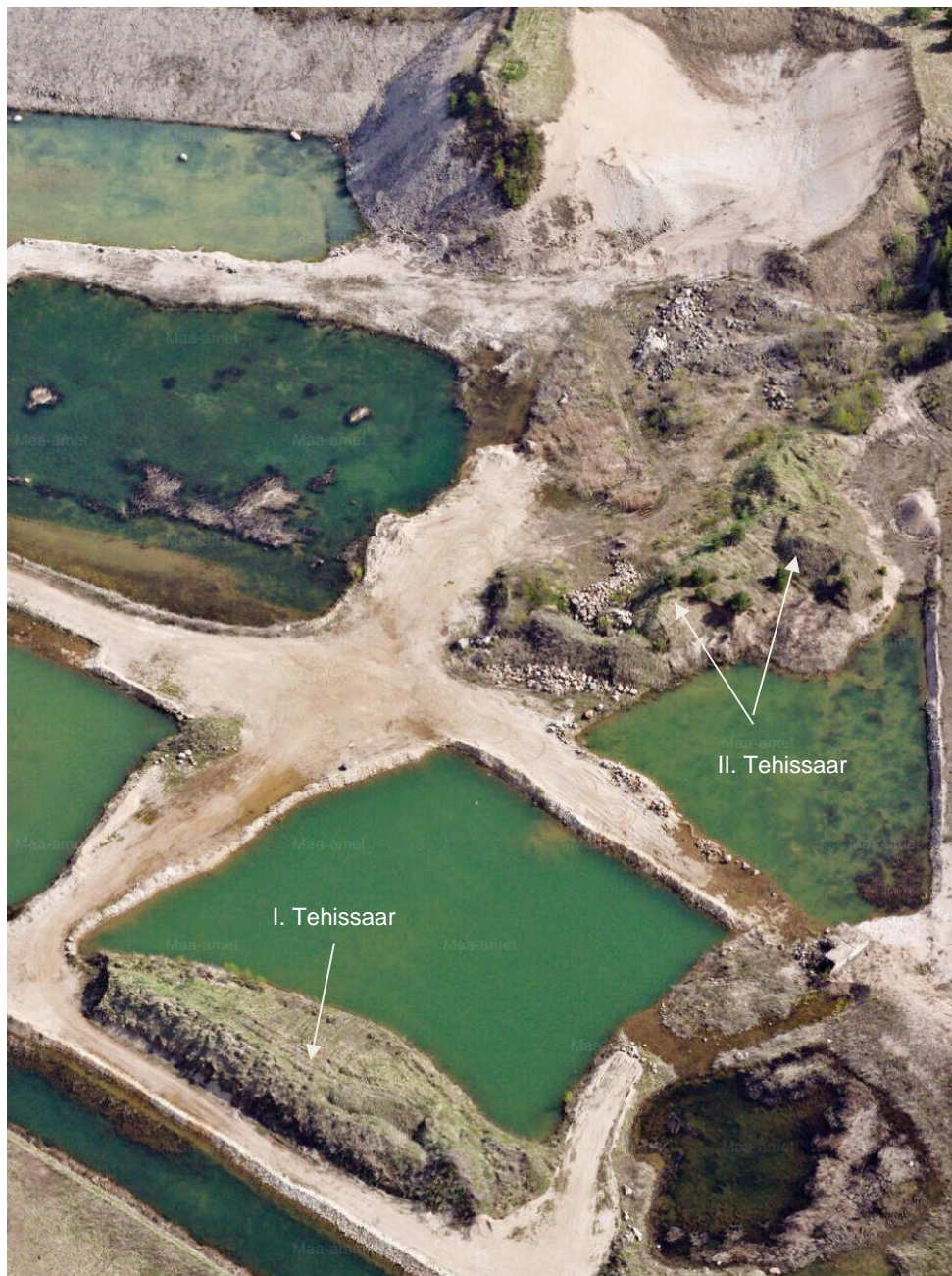
Joonis 7. Tehissaared. II. Tehissaarel tuleb teostada materjali kokku lükkamist ja tasandamist. Foto: Maa- ja Ruumiamet (pildistuse aeg: 2023.05.09)
